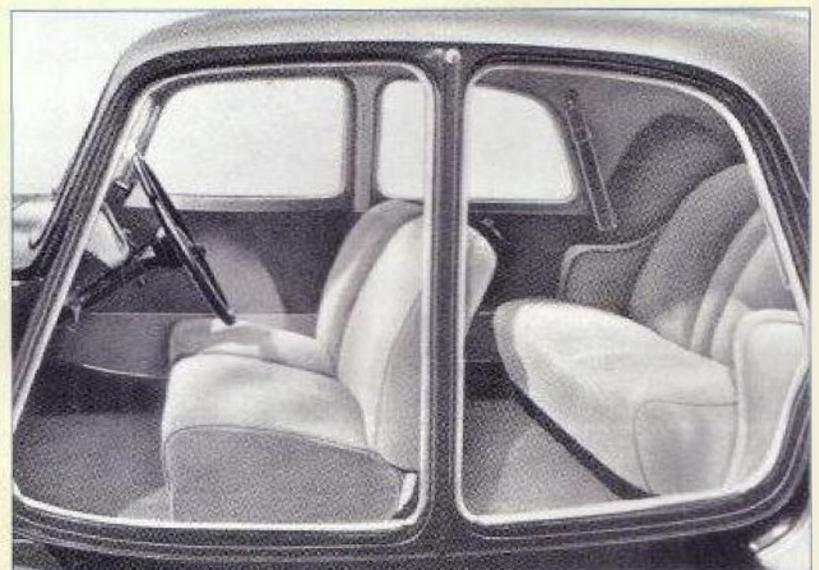
Ci-desms. Les sieges Pullman et l'habitacle de In 1S-Six D 1953, 0-e.orure. Detail de in confortable banquette arriere des 15-Six D 1953, complitee par des accoudoirs central et latratxx,
